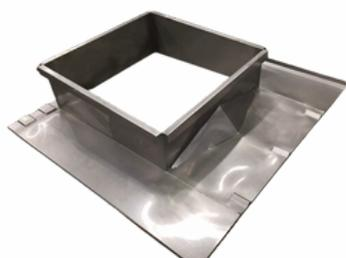
Están diseñados de acuerdo a los requerimientos del equipo de A/C, chimenea o ducto que penetra la cubierta. Fabricados en acero galvanizado o acero inoxidable (cal. 14, 16 o 18), se dimensionan de forma que garanticen una correcta hermeticidad de la cubierta y un correcto soporte del equipo, Cuentan con lapas metálicas que se fabrican según las características del sistema de cubierta.
